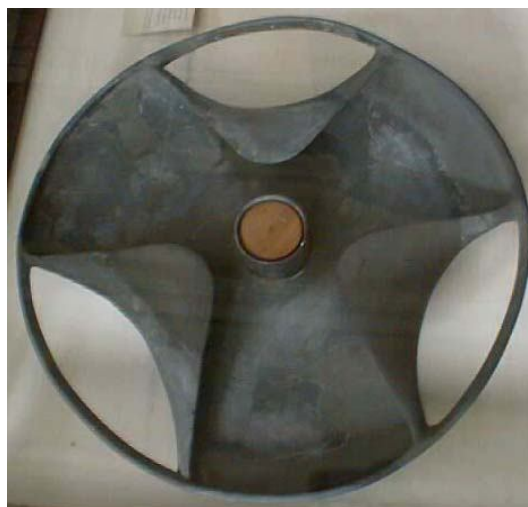
Рисунок 18: Маховое колесо с облегченным ободом.
