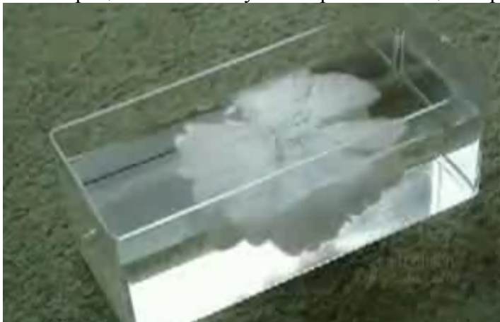
Рис.1 Кристаллизация переохлажденной воды в чашке. Автор фильма в предыдущих кадрах коснулся пальцем поверхности воды, после чего начался процесс образования льда в толще воды. Закончился процесс замерзанием всей воды в чашке.
