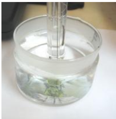
Рис.2. pH дистиллированной воды в центре сосуда и у его внутренней стенки. Из 70 измерений только в 5 случаях разности между вариантами не было.
