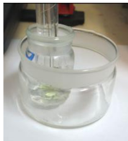
Рис.3. pH дистиллированной воды в маленьком бюксе, расположенном в центре большего сосуда и у его внутренней стенки. Из 60 измерений только в 2 случаях разности между вариантами не было.
