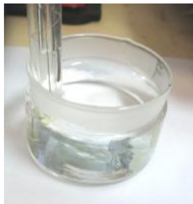
Рис.2. pH дистиллированной воды в центре сосуда и у его внутренней стенки. Из 70 измерений только в 5 случаях разности между вариантами не было.
